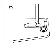
6. Открутите винт фиксатора двери
