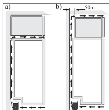
Извлеките из прилагаемого к машине пакета два распорных элемента, обеспечивающих зазор между стенами и прибором и закрепите их согласно рисунку, расположенному вверху на задней стороне прибора, с тем чтобы между стенами и прибором появилось необходимое пространство для вентиляции.
