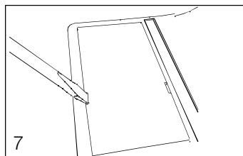
7. Снимите две крышки на крыше
