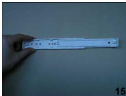
15. Возьмите крепежную скобу (L) поместите ее между двумя отметками, которые вы сделали в п.14. Проверьте с помощью спиртового уровня горизонтальность расположения скобы перед тем, как вы отметите отверстия под винты.
