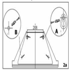
Для отверстий, которые вы отметили в шаге 2, используйте сверло Ø6 мм.
