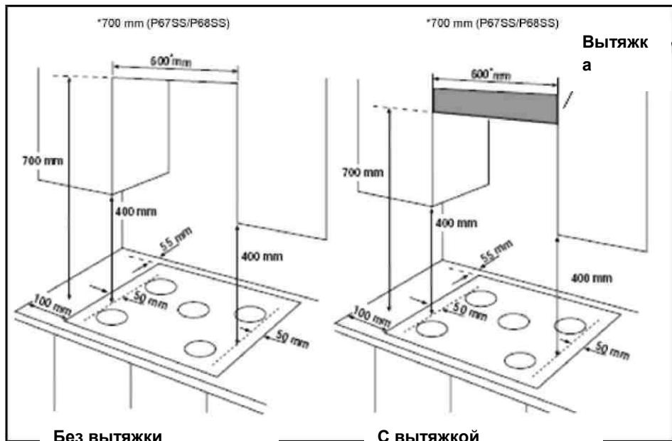
в 50 мм от наружного края варочной поверхности;
