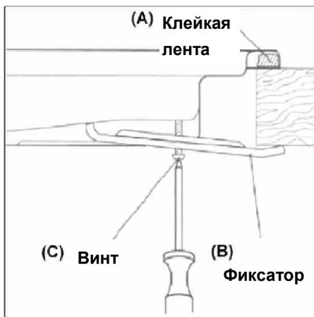
через фиксатор **(В)** так, чтобы фиксатор был прикреплен к варочной поверхности, но Вы все еще могли регулировать его положение.
