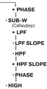
3-3. Нажмая клавишу [P.CH] в верхнем или нижнем направлении, отрегулируйте параметры «**HPF**», «**HPF SLOPE**», «**PHASE**», «**LPF**» и «**LPF SLOPE**».
