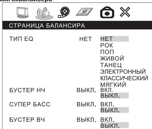
При прослушивании CD/VCD-дисков, записанных с двухканальным звуком, либо при выборе режима PCM цифрового выхода в меню установок системы, либо когда на вход подается аудиосигнал, можно установить один из режимов объемного звучания, включить или выключить режим подъема низких частот (bass boost), супербас, а также режим подъема высоких частот (treble boost).
