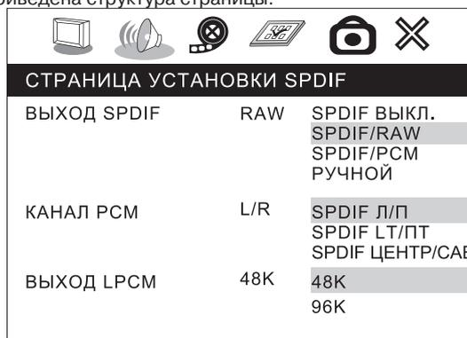
Данная функция предназначена для настройки цифрового аудиовыхода на внешний аудиодекодер.
