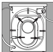
Транспортировочные винты должны быть удалены до того, как вы начнете пользоваться машиной. Обработавшиеся отверстия закройте пластиковыми заглушками (входят в комплект поставки машины).
