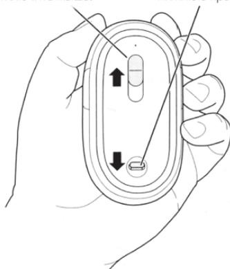
Сдвиньте защелку вниз, чтобы снять нижнюю крышку.
