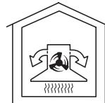
Всасываемый воздух очищается жироулавливающими фильтрами и дополнительно **угольным фильтром**. Через отверстия в телескопической трубе вытяжки воздух попадает обратно в кухню.
