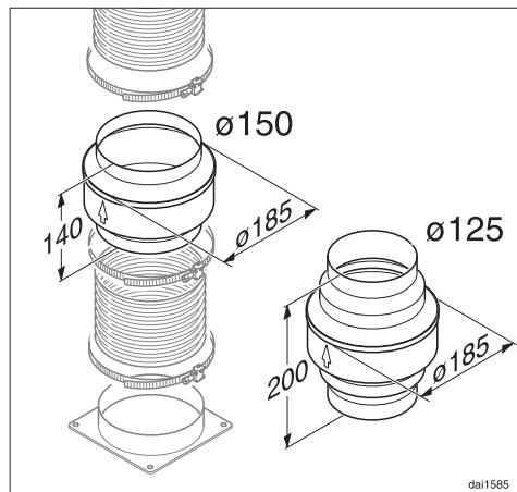
Кроме оснащения воздуховода соответствующей изоляцией, рекомендуется также монтаж данной заслонки, которая улавливает и испаряет образующийся конденсат. Соответствующую заслонку можно приобрести для воздуховода Ø 125 или Ø 150 мм.
