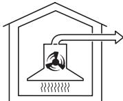
Всасываемый воздух очищается жироулавливающими фильтрами и выводится наружу.
