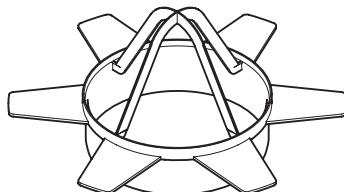
**1 штуцер воздуховода** позволяет изменить положение отверстия для воздуховода в потолке (не у приборов модельного ряда ...U).
