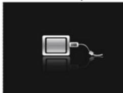
После соединения MP3 плеера с компьютером и включения плеера все операционные системы, за исключением Windows 98 SE, опознают его автоматически, и в папке **“Мой компьютер”** появится доступная для запуска иконка **“Съемный диск”**.
