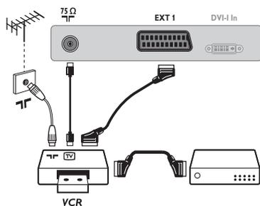
Осуществите указанные на рисунке подключения. Используйте шнур "перитель" хорошего качества. Если у вашего видеомагнитофона нет разъема перитель (или если этот разъем уже занят другой аппаратурой), то возможна лишь связь через кабель антенны. В этом случае вы должны найти тест-сигнал вашего видеомагнитофона и присвоить ему номер программы 0 (см. ручное запоминание, стр. 6). Для воспроизведения изображения видеомагнитофона нажать на клавишу 0.
