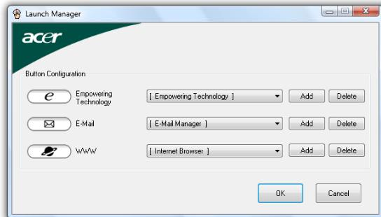
Программа Launch Manager позволяет задавать действия для 4 кнопок быстрого запуска, расположенных над клавиатурой. См. "**"Кнопки быстрого запуска" на стр. 30**", где показано расположение кнопок быстрого запуска.
