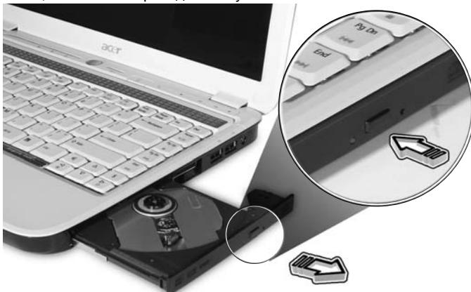
При отключенном питании лоток привода можно открыть, вставив тонкий стержень в отверстие аварийного извлечения.
