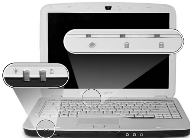
Индикаторы на передней панели видны даже при закрытой крышке компьютера.
