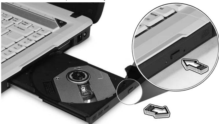
При отключенном питании лоток привода можно открыть, вставив тонкий стержень в отверстие аварийного извлечения.
