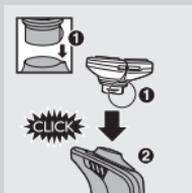
**7** Вставьте выступ бритвенного блока в паз на верхней части бритвы (1). Затем надавите на бритвенный блок (2), чтобы присоединить его к бритве (должен прозвучать щелчок).
