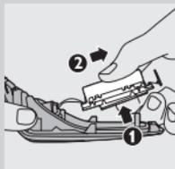
**8** Вытащите провода из блока электродвигателя и извлеките аккумулятор.
