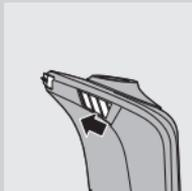
**3** Чтобы выдвинуть триммер, сдвиньте вперед ползунок включения/выключения триммера.
