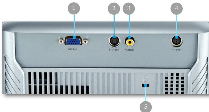
1. Разъем VGA-In SCART (аналоговый сигнал ПК/HD/компонентный входной видеосигнал)
