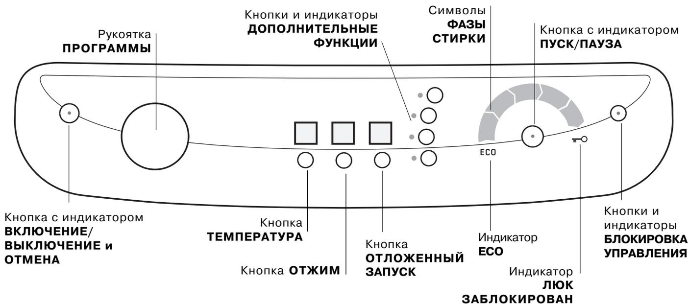
Кнопка с индикатором **ВКЛЮЧЕНИЕ ВЫКЛЮЧЕНИЕ и ОТМЕНА**: нажмите кнопку для включения или выключения машины. Зеленый индикатор показывает, что машина включена. Для отключения стиральной машины в процессе стирки необходимо держать нажатой кнопку, примерно 2 секунды. Короткое или случайное нажатие не приведет к отключению машины. В случае отключения машины в процессе стирки текущий цикл отменяется.
