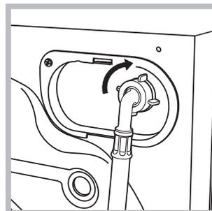
1. Подсоедините шланг к машине, привинтив его к специальному крану, расположенному в задней верхней части справа (см. рисунок).
