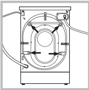
2. Снимите 4 винта, предохраняющие машину в процессе перевозки, и распорки, расположенные в задней части машины (см. рисунок).
