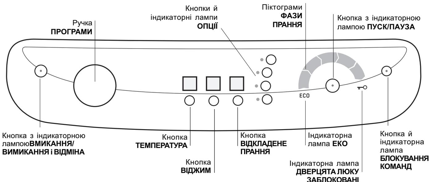
Кнопка з індикаторною лампою **ВМИКАННЯ, ВИМИКАННЯ і ВІДМІНА**: швидко натисніть і відпустіть кнопку для вмикання або вимикання машини. Зелена індикаторна лампа означає, що машина ввімкнена. Для вимикання пральної машини під час прання необхідно утримувати кнопку натиснутою приблизно більш ніж 2 сек.; короткочасне або випадкове натискання не дозволить вимкнути машину. Вимикання машини під час циклу прання анулює дане прання.
