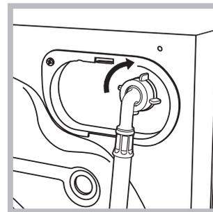
1. Підключіть шланг подачі води до машини, під'єднавши його до виходу на задньому боці угорі праворуч (див. малюнок).
