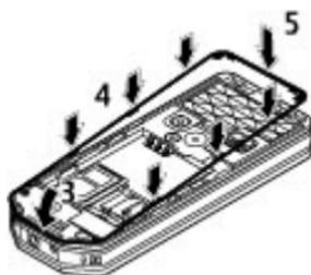
4. Присоедините заднюю панель устройства и проверьте, что она надежно закрыта.
