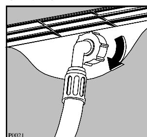
Другой конец наливного шланга, подключающийся к машине, может быть повернут в любом направлении. Ослабьте гайку, поверните шланг и вновь затяните гайку, проверив отсутствие течей воды. Наливной шланг нельзя вытягивать. Если он слишком короткий, и вы не хотите передвигать кран, то вам следует купить новый, более длинный шланг, специально предназначенный для данных целей.
