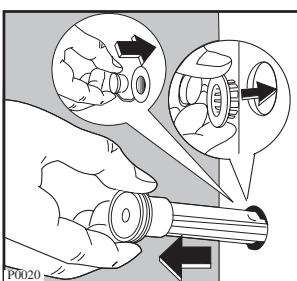
7. Закройте отверстия пластмассовыми пробками, которые вы найдёте на задней панели машины.
