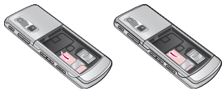
Установка SIM-карты Извлечение SIM-карты
