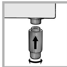
При необходимости выровнять изделие вкрутите в специальные отверстия по углам в основании кухонной плиты прилагающиеся регулировочные ножки\* по (см. рисунок).
