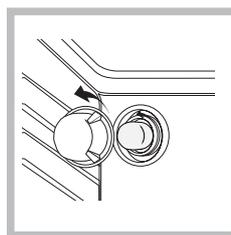
1. Отключите духовой шкаф от сети электропитания, снимите стеклянную защитную крышку лампы (см. рисунок).
