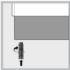
При необходимости выровнять изделие вкрутите в специальные отверстия по углам в основании кухонной плиты прилагающиеся регулировочные ножки (см. рисунок).
