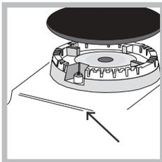
Если изделие оснащено электронной системой зажигания\* (см. рисунок), вначале нажмите кнопку зажигания, обозначенную символом
