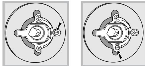
3. проверьте, чтобы конфорка не гасла при резком повороте крана из положения максимального пламени в положение минимального пламени.
