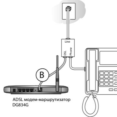
Примечание: Неправильное соединение фильтра к модему блокирует сигналы ADSL и препятствует соединению с Интернетом.
