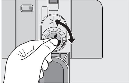
Дозировка установлена заводом-изготовителем в положение 4.
