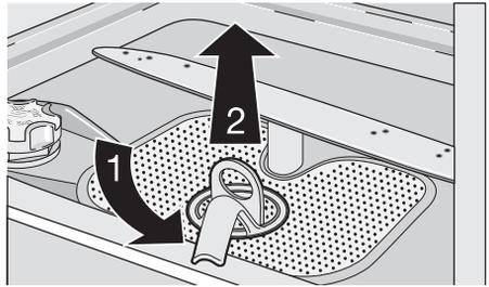
4. Взявшись за ручку с отверстием, извлеките фильтр грубой очистки (А) из микрофильтра (В).
