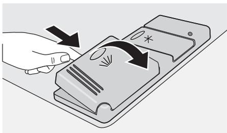
2. Заполните дозатор моющего средства (1) моющим средством. Маркировка указывает на уровни дозировки:
