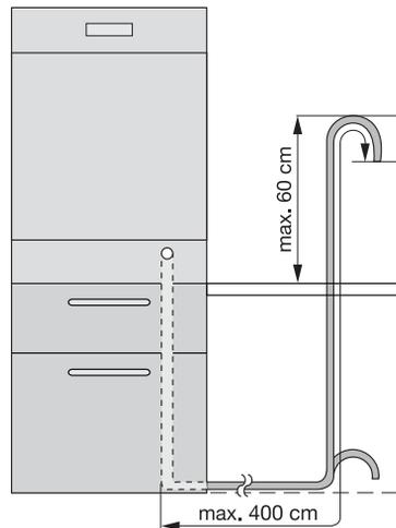
При использовании удлинителя сливного шланга его длина должна быть не более 2 метров, а внутренний диаметр - не меньше диаметра используемого шланга.
