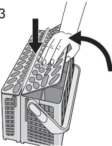
Корзина для столовых приборов состоит из двух частей, которые для более удобного проведения загрузки можно разделять. Чтобы разделить обе части корзины, сдвиньте их по горизонтали в противоположных направлениях и разъедините (рис. 4). Для соединения частей корзины выполните обратную процедуру.
