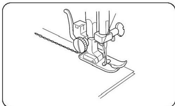
Эта строчка, которую непросто разорвать, образуется двумя стежками вперед и одним назад. Перед созданием шва изделие следует сначала наметать.
