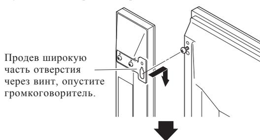
Временно закрепите нижний фиттинг для установки громкоговорителя при помощи имеющегося в комплекте винта (одно место внизу).
