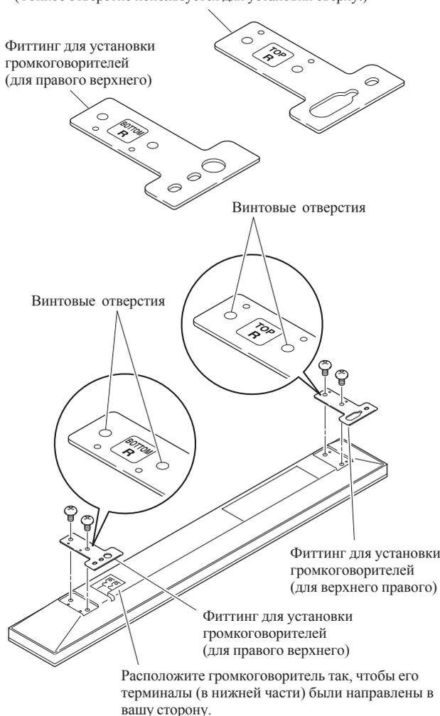
**2. Завинтите имеющийся в комплекте винт в установочное отверстие громкоговорителя (нижнее из двух) сверху, на задней части дисплея.**
