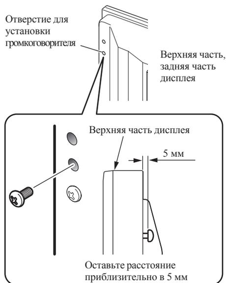
**3. Повесьте фиттинг для установки громкоговорителя на винт, который вы установили наверху - продев его через широкую часть и опустив его в щель; временно завинтите нижний винт.**
