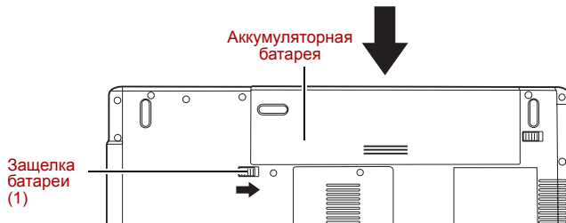
Закрепление батарейного отсека питания
