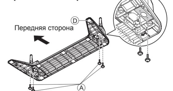
Используйте сборочные винты (A), чтобы надежно прикрепить опоры к нижней части основания.
