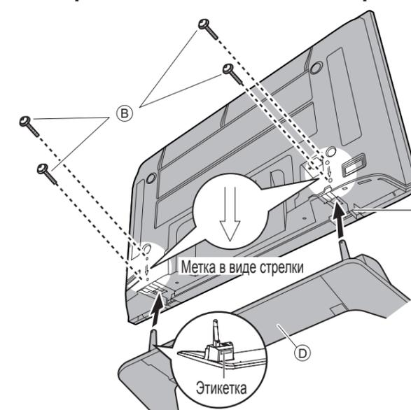
Выполняйте работу на горизонтальной и ровной поверхности. Используйте сборочные винты (B), чтобы надежно закрепить.
