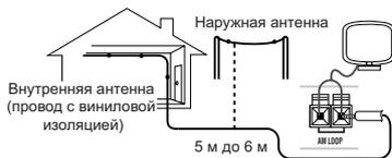
Для подключения внешней антенны FM используйте разъем PAL.
