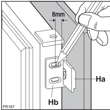
8. Откройте дверь морозильника и шкафа приблизительно на 90°. Вставьте кронштейн (Hb) в направляющую (Ha). Удерживайте двери прибора и шкафа вместе и отметьте отверстия, как показано на рисунке.
