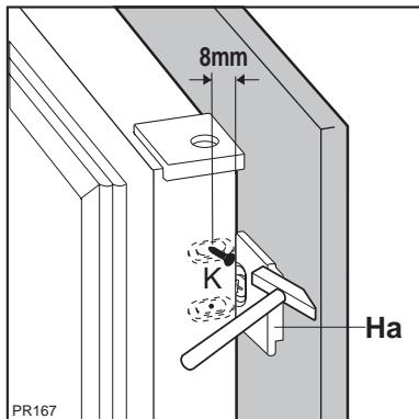
9. Снимите кронштейны и сделайте гвоздем отметку на расстоянии 8 мм от наружного края (K).
