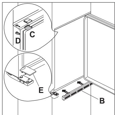
4. Установить вентиляционную решётку (B) и накладку петли (E), защёлкнув их.
