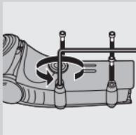
**2** Дождитесь остановки электродвигателя включенной бритвы, затем отвинтите два винта в отсеке для волос и снимите отсек.
