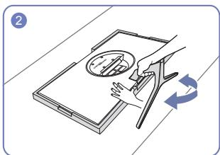
Чтобы отсоединить подставку от монитора, обязательно нажмите на нижнюю часть монитора одной рукой и потяните стенд из стороны в сторону другой рукой, чтобы создать некоторый зазор между ними.
