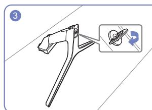
Полностью закрутите соединительный винт в нижней части подставки, чтобы как следует зафиксировать соединительный элемент.
