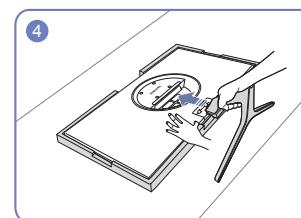
Положите на пол защитный пенопластовый материал (стирофон), входящий в комплект, и разместите на нем устройство экраном вниз, как показано на рисунке. При отсутствии защитного материала используйте толстый коврик.
