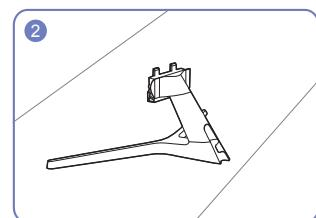
Проверьте, надежно ли закреплен соединительный элемент подставки.
