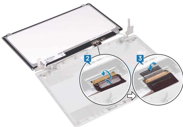
4. Установите панель дисплея на заднюю крышку дисплея и антенну в сборке.
