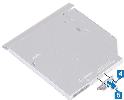
6. Аккуратно потяните лицевую панель оптического дисковод и снимите ее с оптического дисковод.
