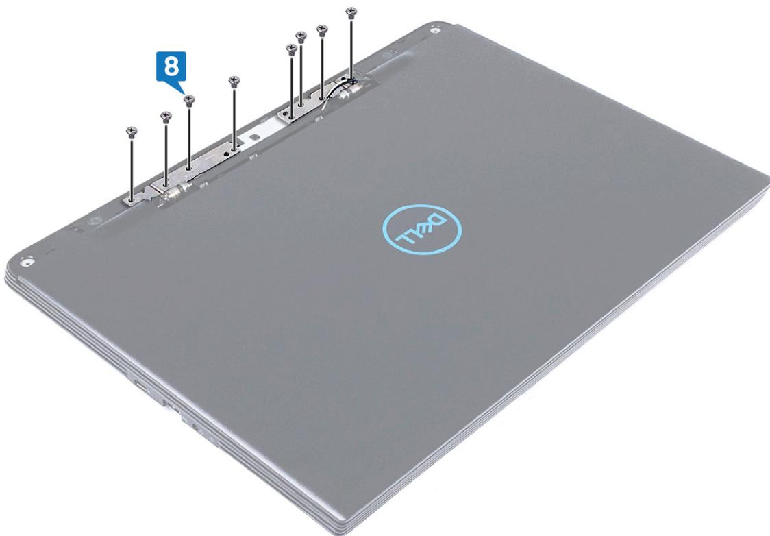
9. Сдвиньте дисплей в сборе вперед и высвободите его из фиксаторов на упоре для рук в сборе.
