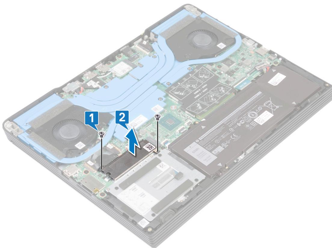
3. Открутите винт (M2x4), которым твердотельный накопитель / модуль памяти Intel Optane крепится к упору для рук в сборе.
