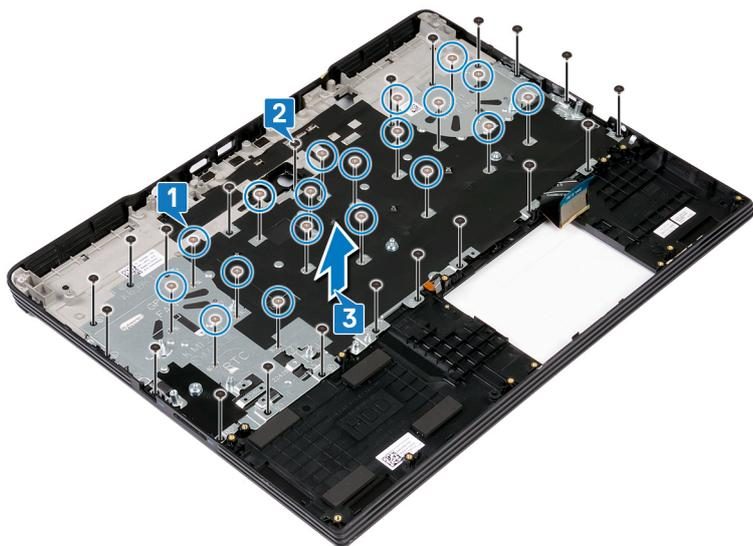
4. Снимите клавиатуру вместе с кабелем с упора для рук в сборе.
