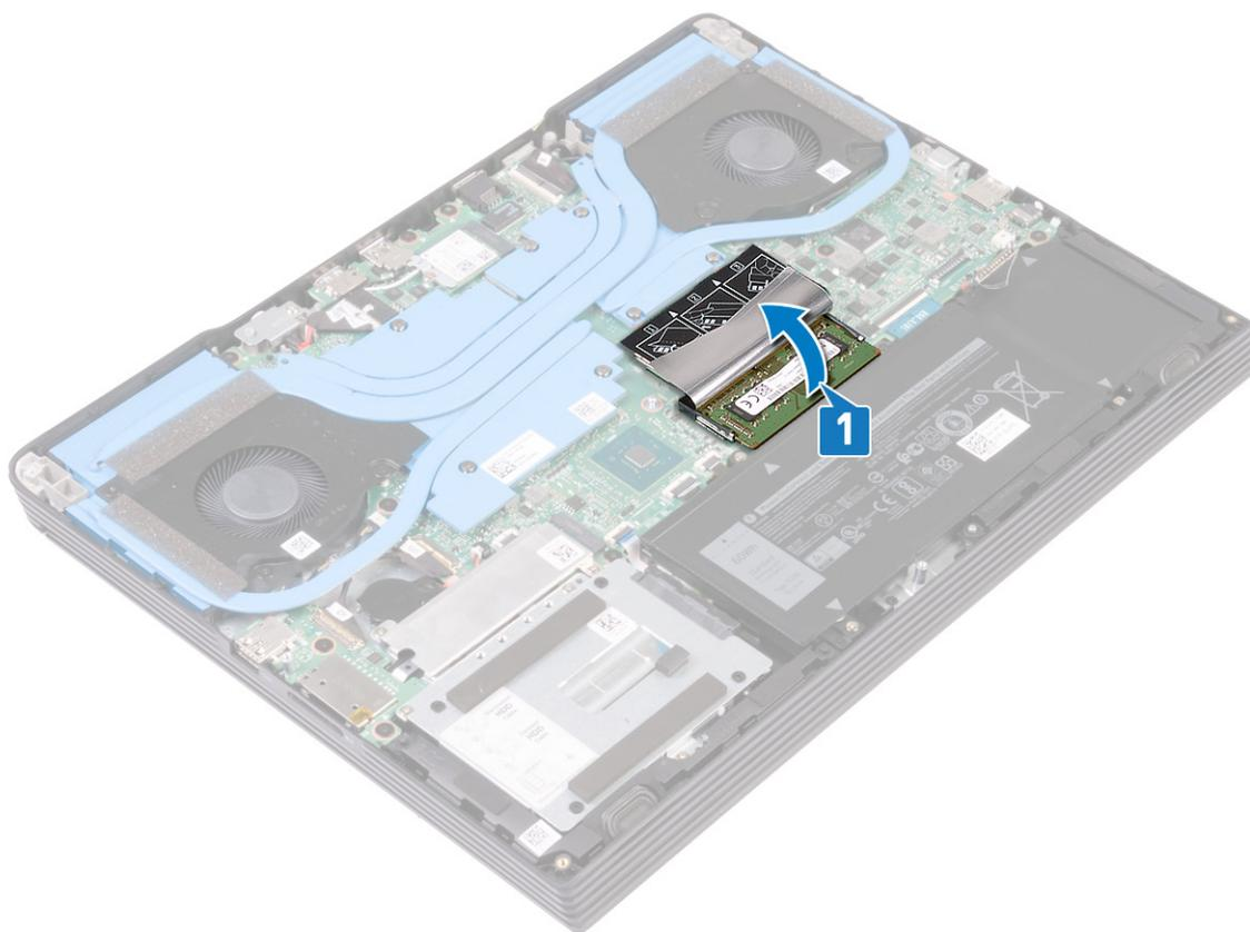
2. Кончиками пальцев аккуратно раскрывайте фиксаторы с каждой стороны разъема модуля памяти до тех пор, пока модуль памяти не выскочит из разъема.
