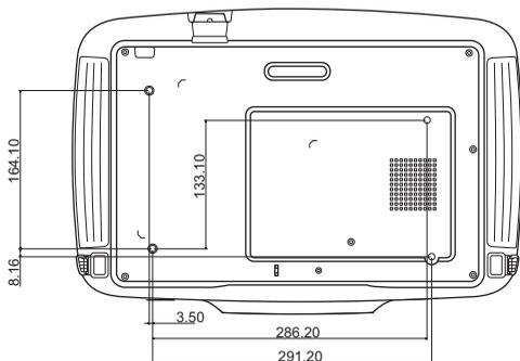
⊙ Винты для крепления на потолке: M4 x 8 (макс. L = 8 мм)
