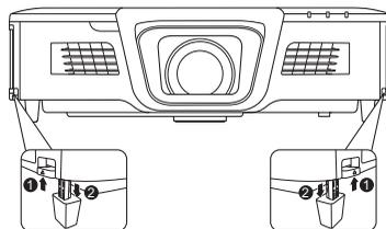
Если проектор стоит на неровной поверхности или не под прямым углом к экрану, то возникают трапециевидные искажения проецируемого изображения. Порядок коррекции этого искажения см. в разделе "[Коррекция трапециевидных искажений](#)" на стр. 32.
