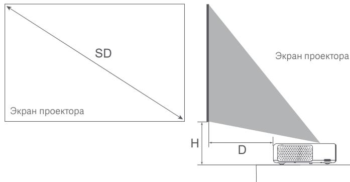
Определение необходимого расстояния между проектором и экраном на основе желаемого размера
