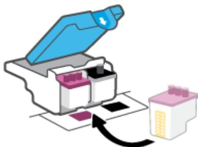
9. Закройте фиксатор печатающей головки. Убедитесь, что фиксатор печатающей головки правильно закрыт, чтобы избежать таких проблем, как застревание каретки.
