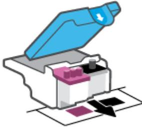
7. Очистите контакты печатающей головки и принтера.
