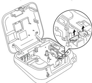
**2.** Установите новый блок обрезки. Надавите на блок, чтобы он встал на место.
