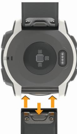
**ПРИМЕЧАНИЕ.** убедитесь, что ремешок закреплен надежно. Фиксатор должен защелкнуться на штырьке часов.
