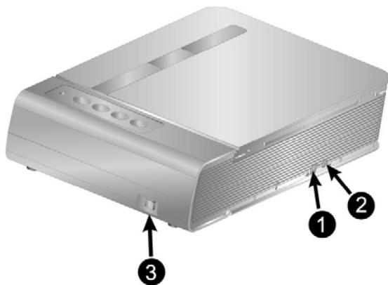
1. **Порт USB:** Подсоединяет сканер к порту USB Вашего компьютера с помощью входящего в комплект сканера кабеля USB.
