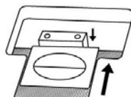
**Режим постоянно отпертой защелки** предназначен для тех случаев, когда поверхность, на которой стоит сканер, непрочная, неустойчивая или слишком мягкая. Кроме того, если Вы собираетесь пользоваться сканером длительное время, Вы также можете выбрать этот режим защелки.
