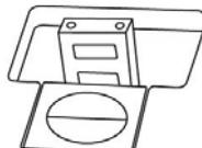
**Автоматический режим** работы защелки предназначен для тех случаев, когда сканер установлен на ровной поверхности. Если головка защелки не нажата, сканер будет запираться автоматически. Такой режим работы защелки рекомендуется для общего пользования.
