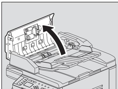
**2** Откройте транспортировочную направляющую и выньте оригинал.
