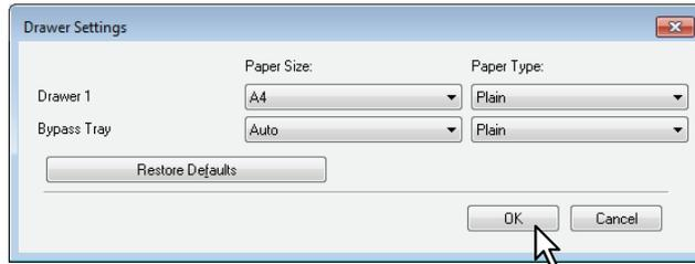
**Drawer 1** — Выберите формат и тип бумаги, загружаемой в кассету. Для кассеты тип бумаги зафиксирован на обычную бумагу, “Plain”.
