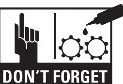
**X5, X8:** Rezni mehanizam nauljite u slučaju smanjenog učinka rezanja, stvaranja šumova ili nakon svakog pražnjenja spremnika uništenog materijala. Za to
