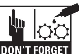
**X5, X8:** Olajozza meg az aprítókészüléket gyengülő aprítási teljesítmény és megnövekedett zaj esetén, illetve az aprítéktartály minden ürítésekor. Ehhez csak speciális HSM aprítóblokk-olajat használjon:
