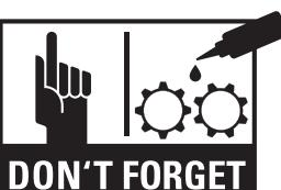
**X5, X8:** Смазывайте режущий механизм маслом при уменьшении производительности, возникновении шумов
