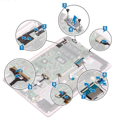
Открутите шесть винтов (M2x2), которыми системная плата крепится к упору для рук и клавиатуре в сборе.
