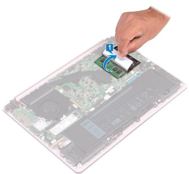
2 Кончиками пальцев аккуратно раскрывайте фиксаторы с каждой стороны разъема модуля памяти до тех пор, пока модуль памяти не выскочит из разъема.
