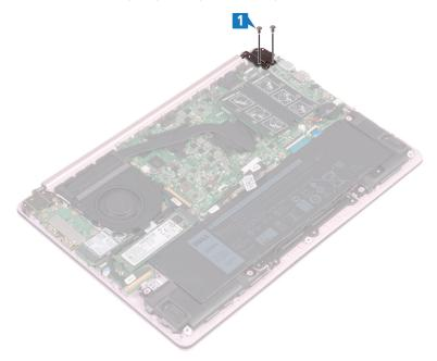
Приподнимите упор для рук и клавиатуру в сборе под углом, чтобы поднять правый шарнир.
