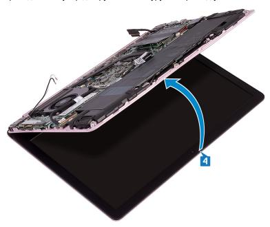
Выдвиньте и снимите упор для рук и клавиатуру в сборе с дисплея в сборе.
