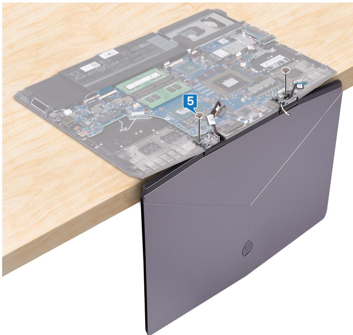
6 Поверните дисплей в сборе внутрь и снимите его с упора для рук в сборе.
