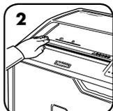
2 Прикоснитесь к контрольной поверхности и проследите, чтобы загорелся индикатор функции SafeSense®
