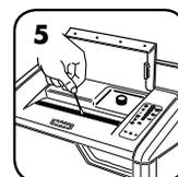
5 С помощью ватного тампона удалите загрязнения с датчиков обнаружения бумаги
