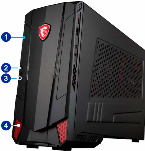
**1****Привод оптических дисков (опционально)**
