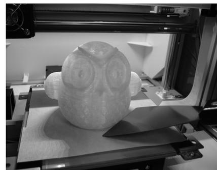
4. Снимите отпечатанный предмет с платформы по окончании печати, когда платформа опустится. Пленка для платформы предназначена для многократного использования и подлежит замене при износе.
