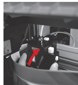
7. После чистки тракта подачи нити снова подсоедините направляющую трубку к верхней части экструдера и установите экструдер на кронштейн.
