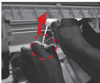
5. Слегка сожмите пружинный фиксатор вокруг отверстия подающего модуля и отсоедините направляющую трубку для нити (не отсоединяйте белый плоский шлейф).
