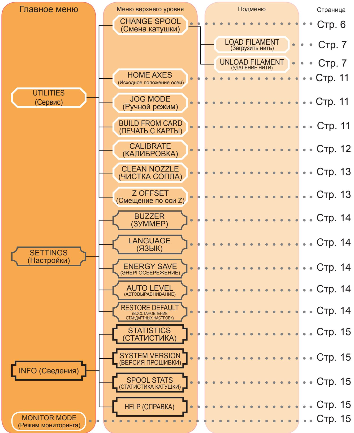
На приведенной выше схеме показаны функции, к которым можно получить доступ с помощью панели управления принтера. Подробное описание каждой функции представлено на соответствующей странице.
