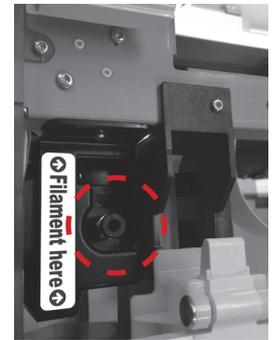
**3** Выведите направляющую трубку через зону перемещения трубки наружу из принтера, а затем вставьте другой конец направляющей трубки в отверстие для трубки на подающем модуле.
