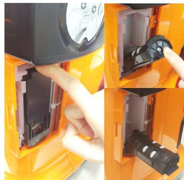
2 Опустите в горизонтальное положение держатель катушки с нитью, расположенный в левой части принтера.
