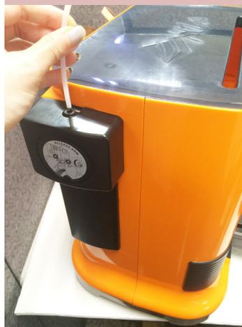
**1** Проверьте надежность установки направляющей трубки для нити в соответствующее отверстие.
