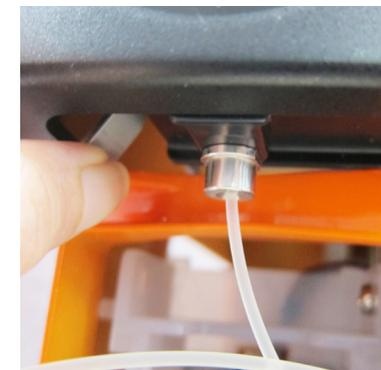
5 Нажмите на рычаг фиксатора и вставьте нить до упора, чтобы ее конец полностью вошел в модуль экструдера.
