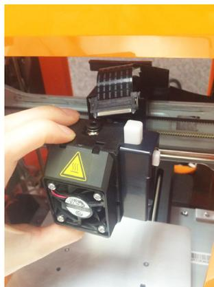
**1** Удостоверьтесь, что принтер выключен. Установите модуль экструдера так, чтобы установочный штифт закрепился в надлежащем положении.
