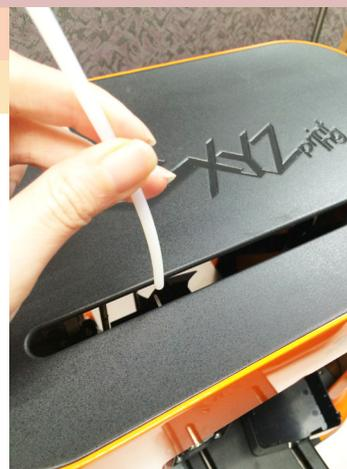
**2** Протяните направляющую трубку через прорезь в верхней части принтера к модулю экструдера.
