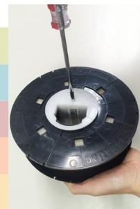
С помощью крестовой отвертки затяните крепежные винты втулки, чтобы завершить установку.
