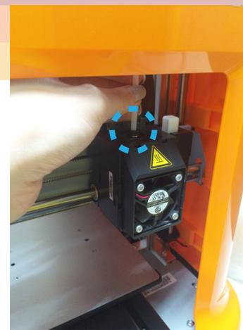
**3** В завершение установки удостоверьтесь, что направляющая трубка правильно подсоединена к подающему отверстию модуля экструдера.
