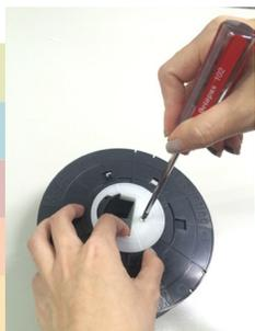
С помощью крестовой отвертки вывинтите крепежные винты втулки катушки с нитью.
