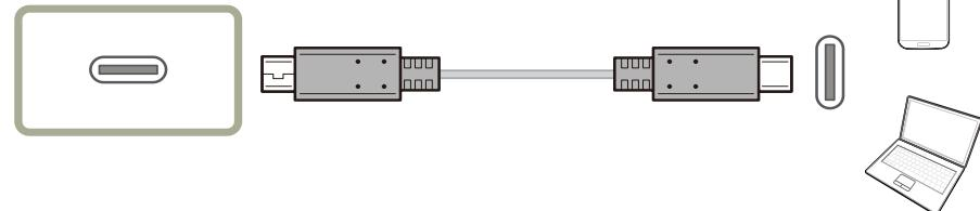
Порт USB Type-C поддерживает функцию передачи питания, данных и видеосигнала DP по кабелям USB.
