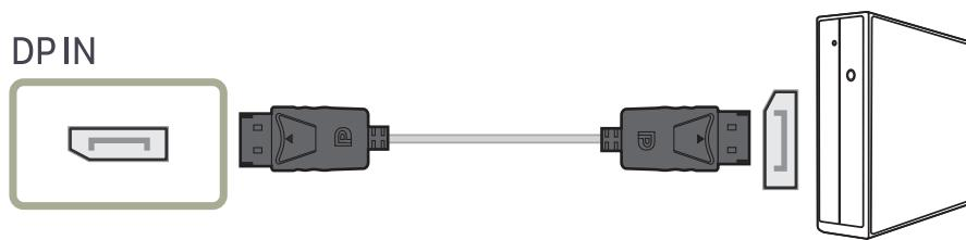
— Используйте только кабель DP, входящий в комплект поставки монитора. При использовании кабеля DP другого производителя качество изображения может ухудшиться. Рекомендуется кабель марки Samsung.
