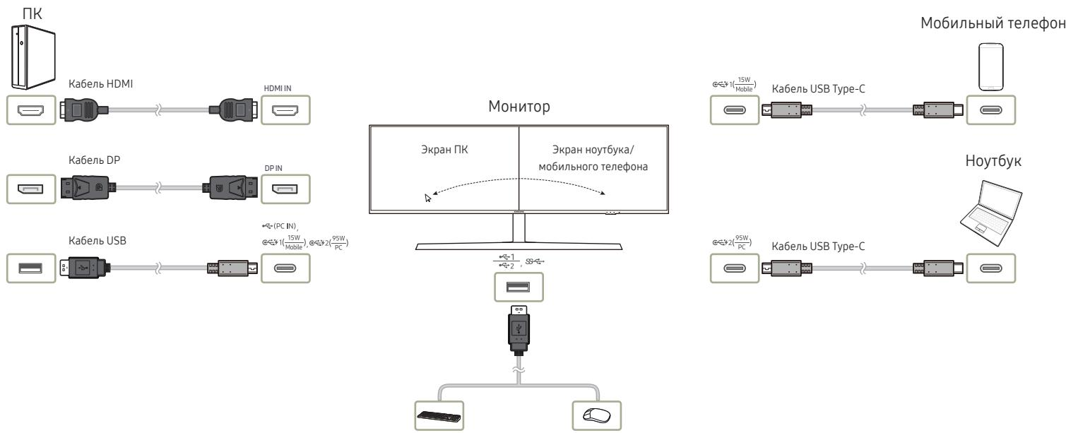
Переключатель KVM (клавиатура, видео и мышь) позволяет пользователям использовать только клавиатуру, видеомонитор и мышь для управления несколькими источниками входного сигнала.
