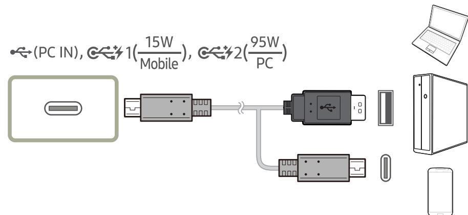
Подключите кабель USB к на задней стороне монитора и к или на исходном устройстве.
