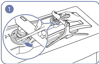
Демонтируйте ОТКРЫТУЮ КРЫШКУ ЗАДНЕЙ ПОДСТАВКИ с помощью тонкого стержня, как показано на рисунке.
