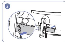
Расположите кабели, учитывая сгибаляемость, и извлеките кабели из НИЖНЕЙ КРЫШКИ ЗАДНЕЙ ПАНЕЛИ.
