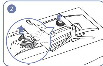
Приподнимите ВЕРХНЮЮ ЗАДНЮЮ КРЫШКУ.
