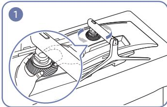
Поверните ВЕРХНЮЮ ЗАДНЮЮ КРЫШКУ против часовой стрелки.
