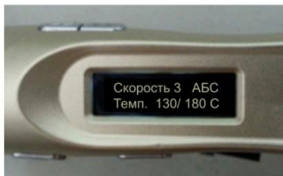
Рисунок 4 - Режим предварительного нагрева нити АБС
