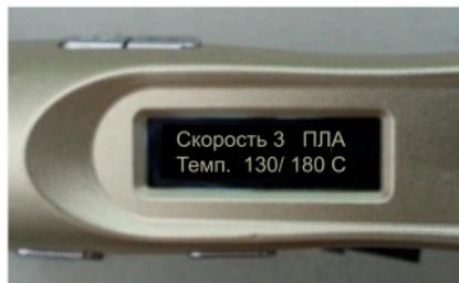
Рисунок 3 - Режим предварительного нагрева нити ПЛА
