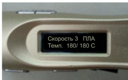
Рисунок 5 – работа с нитью ПЛА
