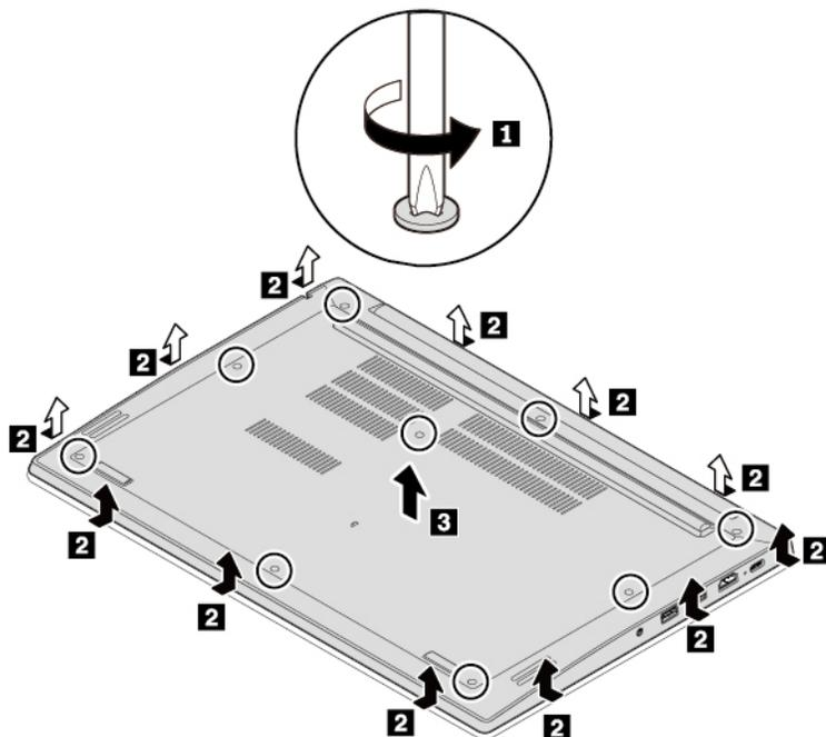
5. Установите новый узел крышки корпуса **1** и убедитесь, что его защелки зафиксировались **2**. Затем затяните винты **3**.
