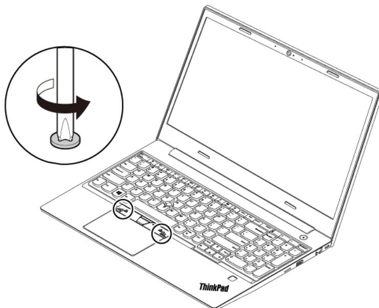
7. Вставьте язычки **c** и **d** в выемки **1**, расположенные рядом с двумя головками винтов.
